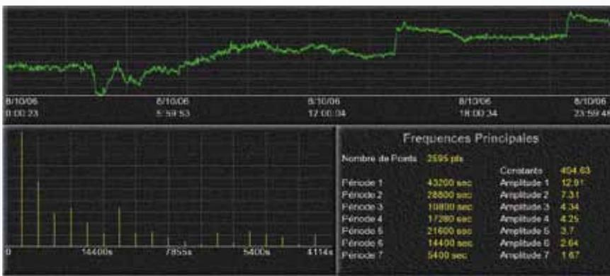
Décomposition en séries de Fourier. Permet de décomposer les mesures en une constante et une série de variations.
