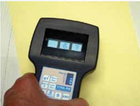
**Des jauges d'humidité infrarouge portable**
