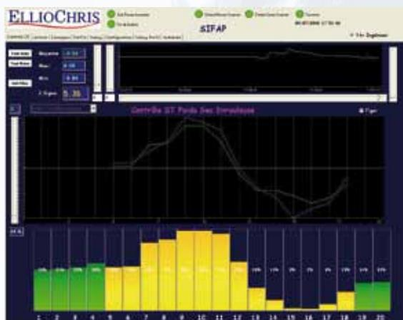
**Système de régulation sens travers complet, logiciel de tuning, modules de raccordement aux différents systèmes QCS du marché.**
