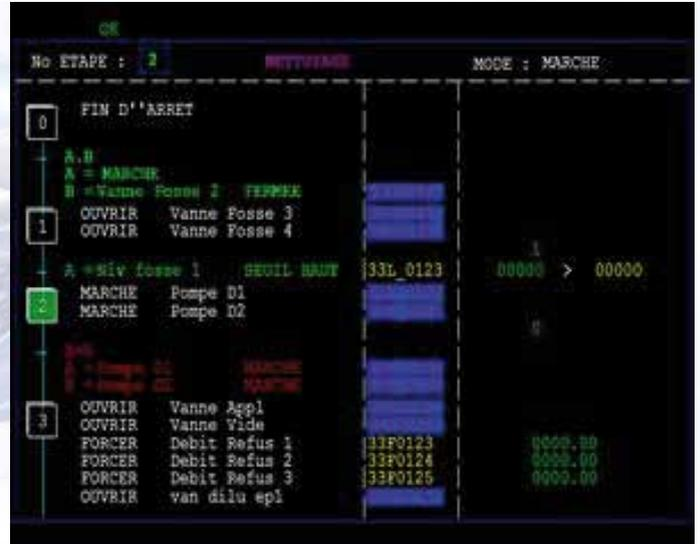
Il s'agit d'un système permettant l'ajout de séquences à un ensemble de systèmes QCS ou DCS. Les systèmes concernés peuvent être de tous types :
