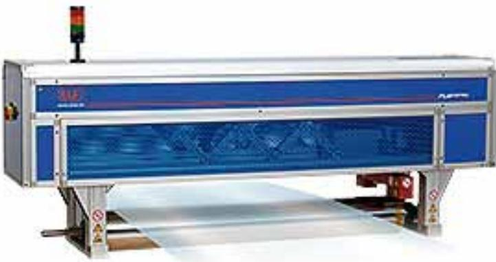
Mesure du profil d'épaisseur sans contact.
